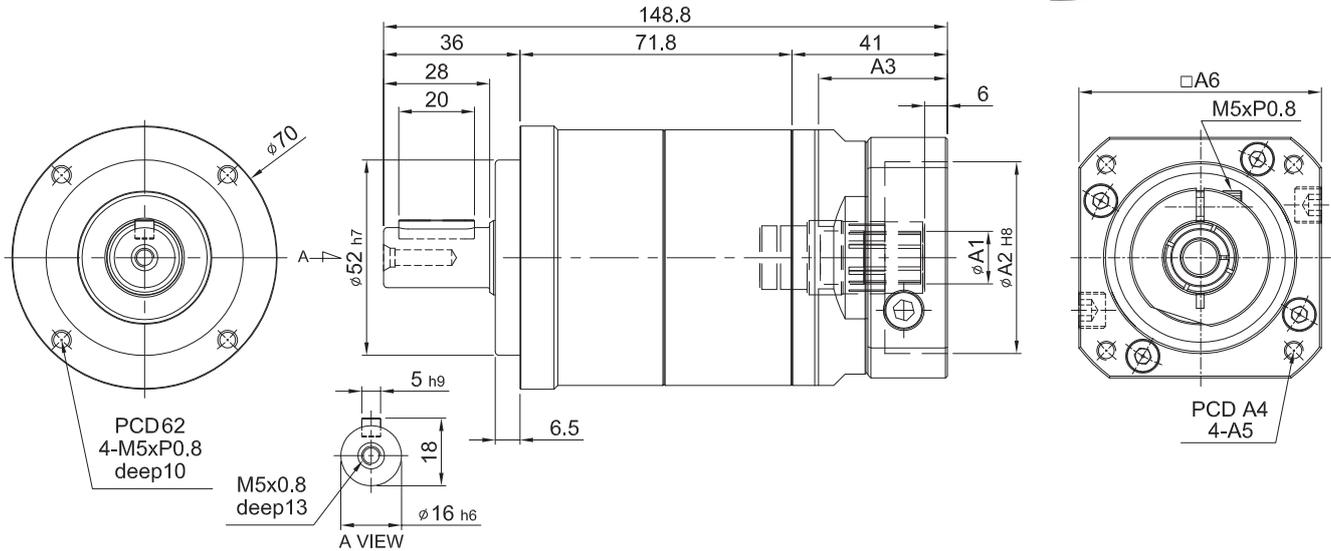
入力法蘭尺寸表 Dimension of Input Flange
