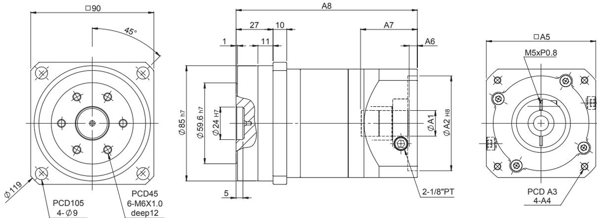
入力法蘭尺寸表 Dimension of Input Flange
