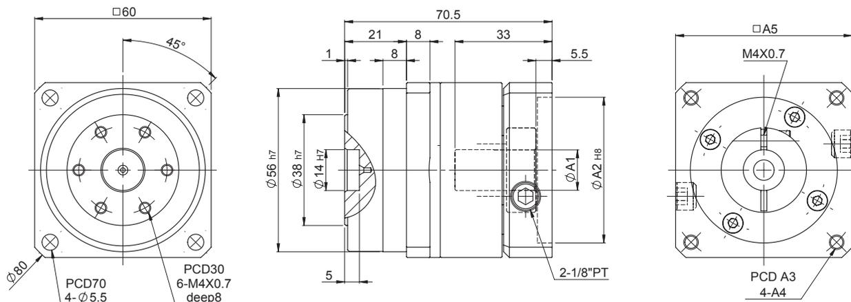
入力法蘭尺寸表 Dimension of Input Flange
