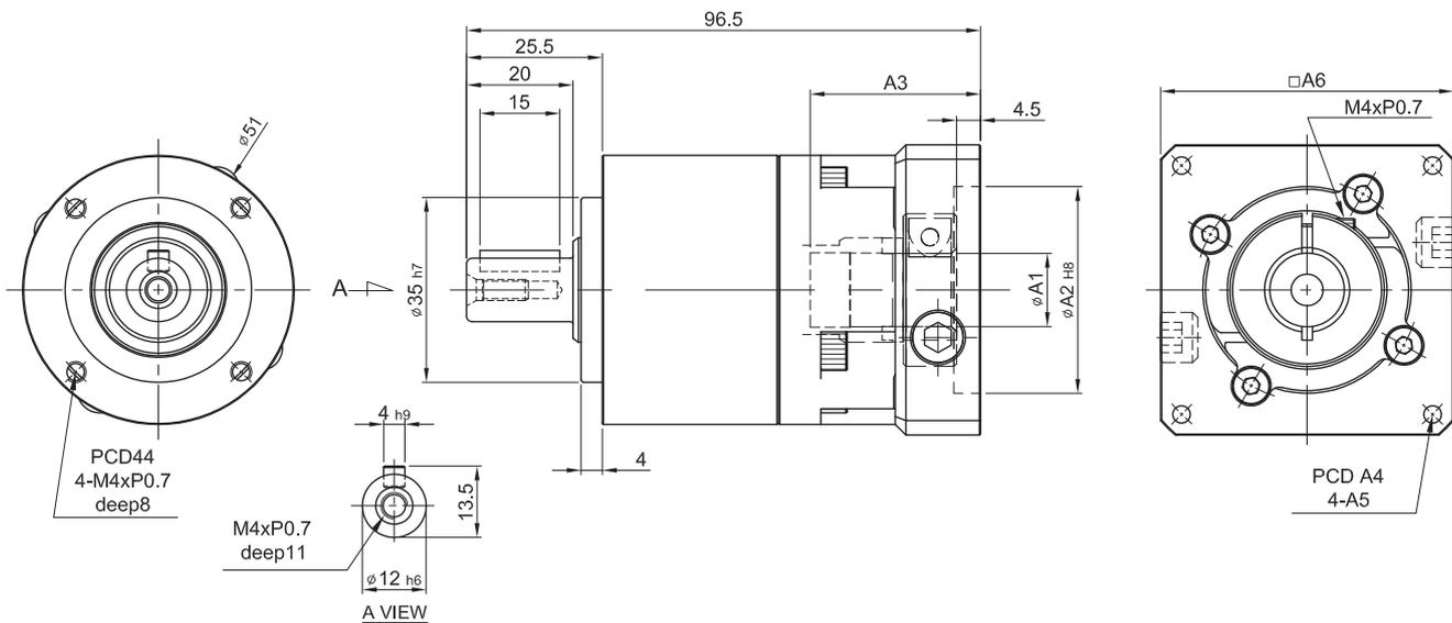
入力法蘭尺寸表 Dimension of Input Flange
