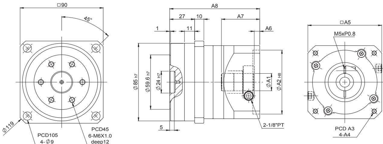
入力法蘭尺寸表 Dimension of Input Flange
