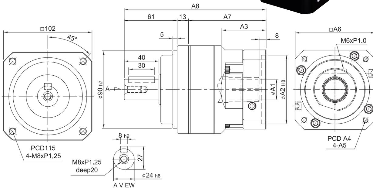
入力法蘭尺寸表 Dimension of Input Flange
