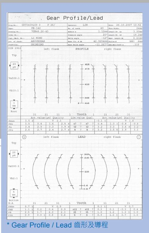
\* Gear Profile / Lead 齒形及導程
