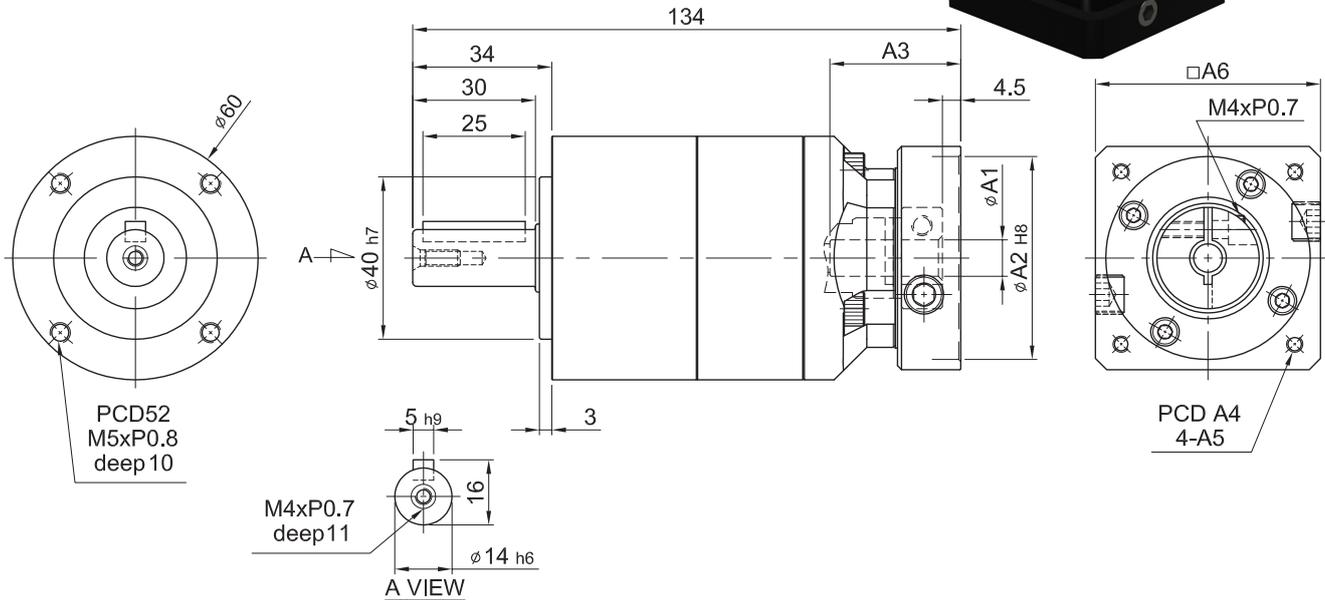
入力法蘭尺寸表 Dimension of Input Flange
