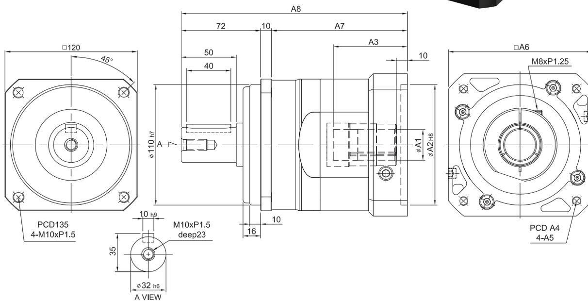
入力法蘭尺寸表 Dimension of Input Flange
