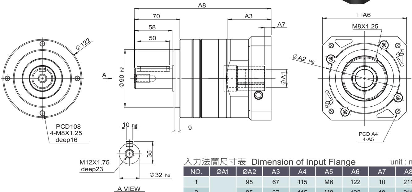
入力法蘭尺寸表 Dimension of Input Flange unit : mm
