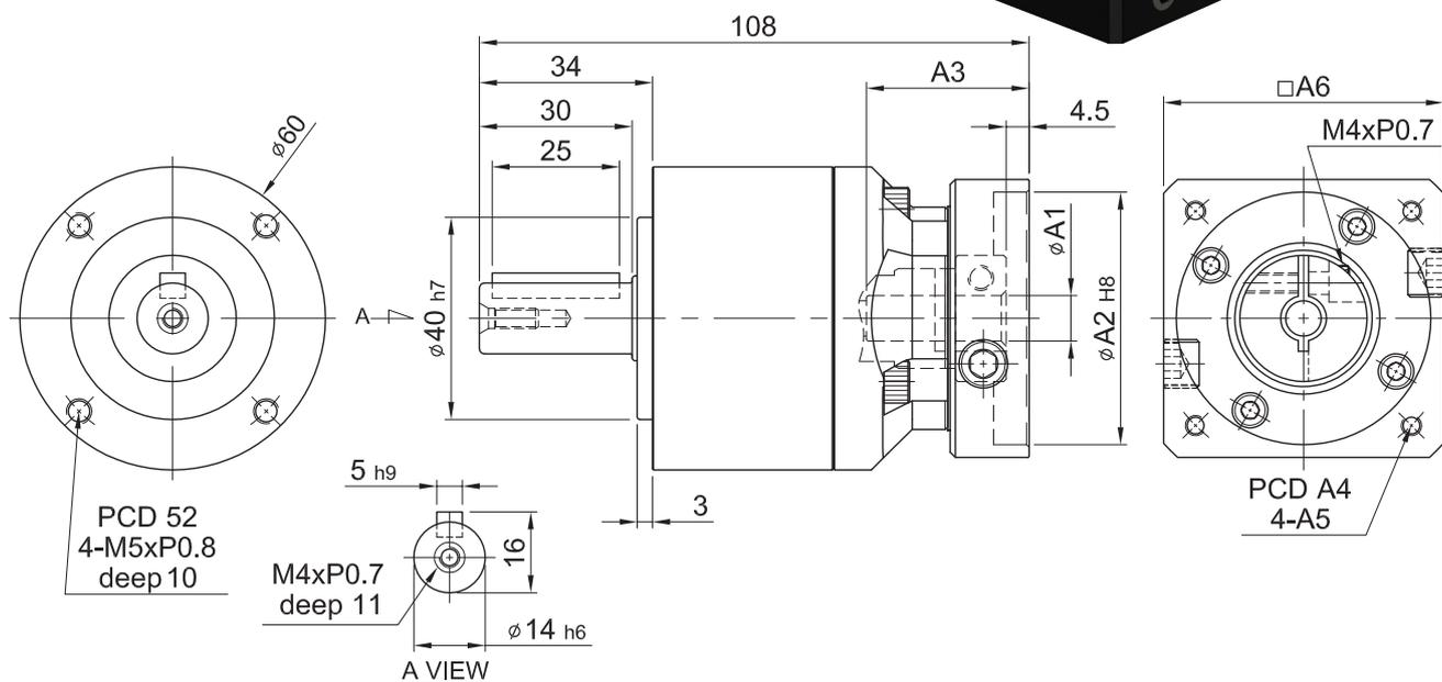
入力法蘭尺寸表 Dimension of Input Flange
